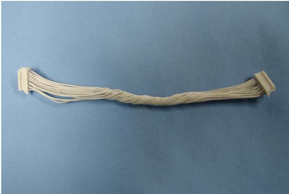
Foto 2. 1. Cable conexión placa LVDS
