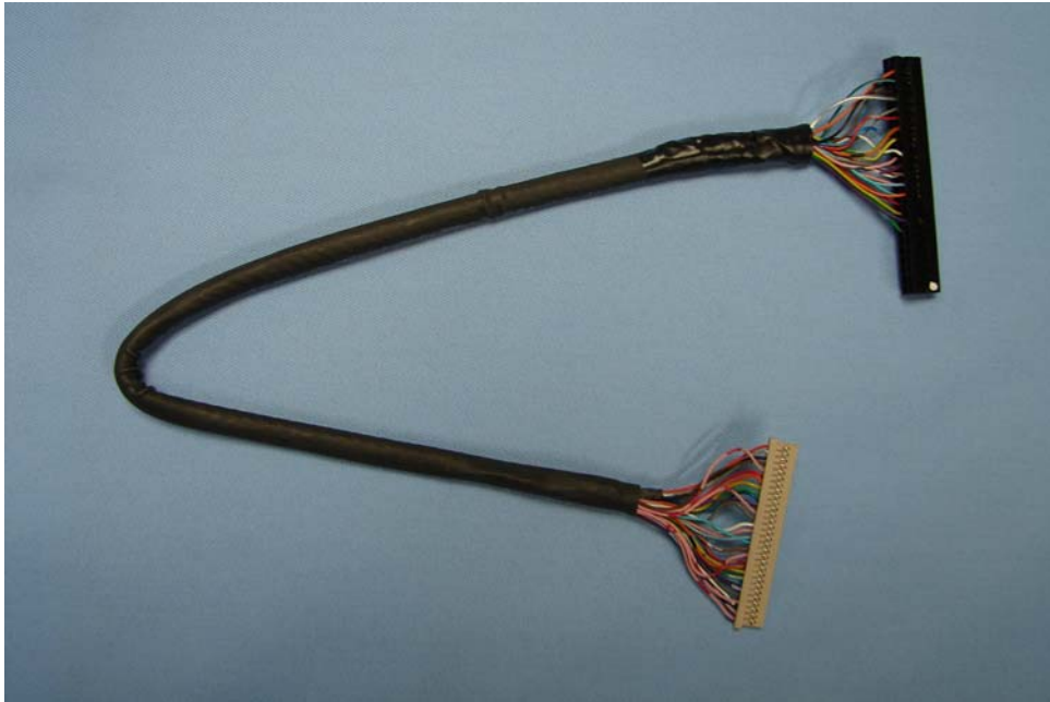
Foto 4. 1. Cable Conexión LVDS
