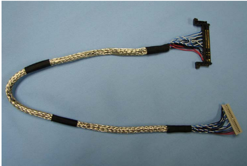
Foto 5. 1. Cable Conexión LVDS
